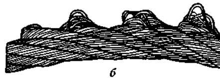
Рис. 5. Выдавливание проволок прядей: a — в одной пряди; б — в нескольких прядях
